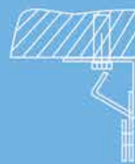
Montage sous linteau
